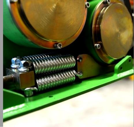
Mit seinem mehr als 3,3 mal größeren Reibspalt im Vergleich zum Standard-Walzencracker spielt der SHARKCUT seine Überlegenheit gerade bei großen Häcksellängen aus. Beispielsweise bei der Ernte von s.g. SHREDLAGE.
